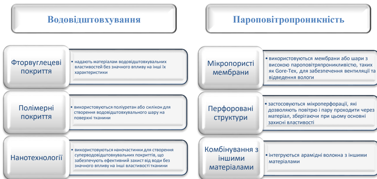
Рисунок 1 – Методи адаптації арамідних матеріалів через спеціальні обробки та технології
